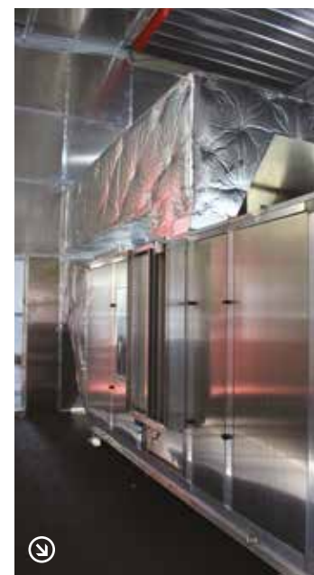
Thereco a investi dans un laboratoire de R & D qui permet de recréer différents climats et de tester la performance des machines.
