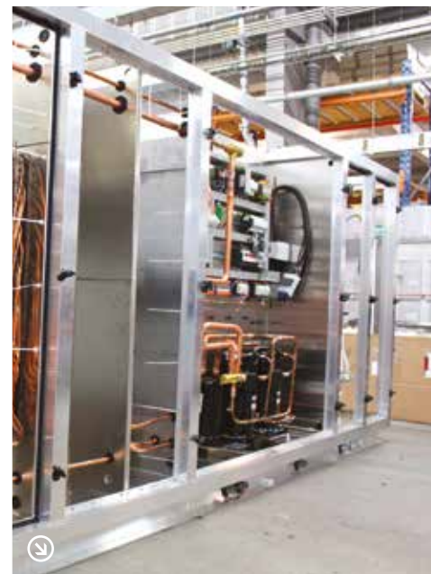
L'armature en aluminium est fabriquée sur place, avant que soient installés les différents éléments : ventilateurs, compresseurs, échangeurs à plaques, tableau électrique...
