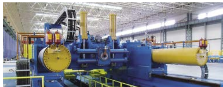
La PME a notamment fabriqué des vérins (en beige sur la photo) pour une presse qui forme la barre en titane reliant les ailes des Boeing 777 au fuselage.
