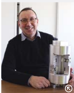
Dominique Bignon a développé des technologies particulières comme ce joint tournant, qui permet d'alimenter des vérins en rotation.
