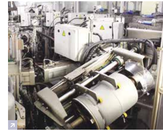
Ce carrousel a été conçu en interne pour pouvoir tester la résistance des bouteilles à la pression.
